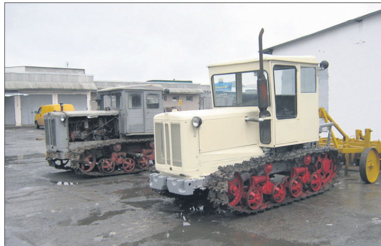
Модифікований трактор Т-74 з новою кабіною та сучасною звукоізоляцією і кондиціонером. Виготовлено ПНТФ "Союз".
